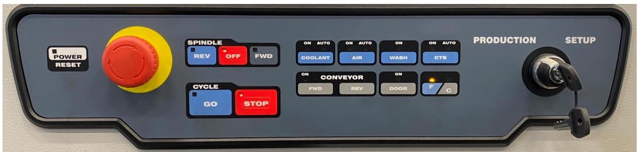
**POWER-RESET:** Diese Taste wird verwendet, um die Maschine aus einem Hardware-Not-Aus-Zustand oder einem "Servos nicht aktiviert-Zustand" zurückzusetzen. Sie muss beim ersten Einschalten und immer dann gedrückt werden, wenn die Steuerung in einen kritischen Fehlerzustand gerät. Zum Beispiel, wenn der Benutzer die Not-Aus-Taste drückt.
